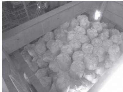
▲成瀬クリーンセンター建物地下に積まれている焼却灰
